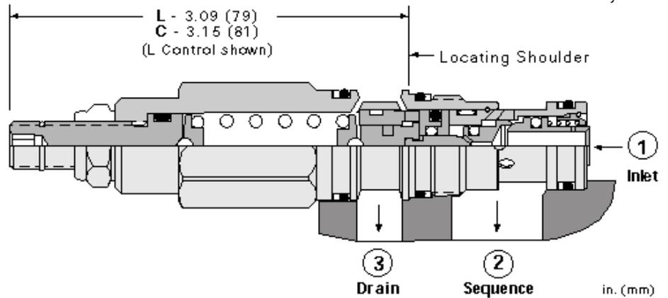
Ein direktbetätigtes Druckfolgeventil mit Rückschlagventil erlaubt den Durchfluss in einen zweiten Kreis, sobald der Druck an Anschluss 1 den Einstellwert des Ventils übersteigt. Zusätzlich verfügt dieses Ventil über ein Rückschlagventil, das den Durchfluss von Anschluss 2 (Folge) nach Anschluss 1 (Zulauf) ermöglicht. Die Druckeinstellung eines Druckfolgeventils regelt den Druck an Anschluss 1 abhängig vom Druck am Leckölanschluss 3.
